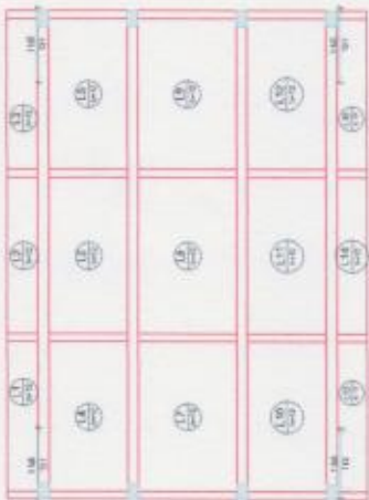
Armação negativa das lajes do pavimento PONTE (Eixo X)
