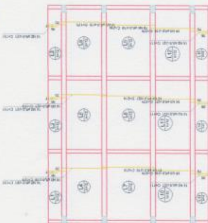
Armação negativa das lajes do pavimento PONTE (Eixo X)
